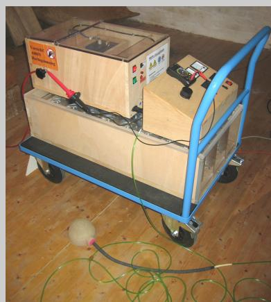
Die **Erweiterungskondensatorbank** beinhaltet ausschließlich 24 MP-Hochspannungskondensatoren und dient dazu, die Speicherenergie der Hauptkondensatorbank zu ergänzen.
