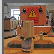
Die schlagartige Kondensatorenentladung erzeugt hierbei zwischen Spule und Dose einen starken magnetischen Druck, wodurch die Dose zusammengequetscht wird. Das besondere hierbei ist, dass dieser Vorgang ohne jegliche mechanische Berührung stattfindet.
