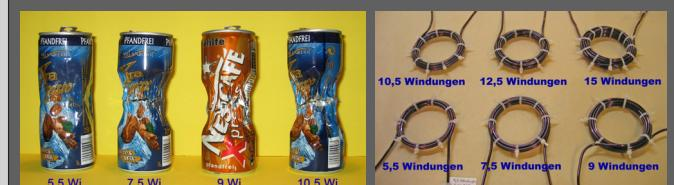
Versuche mit verschiedenen Dosenarten zeigten, dass nur Alu-Dosen effizient zerquetscht werden können. Eisenhaltige Weißblehdosen lassen sich nur sehr geringfügig verformen. Der dadurch bedingte ferromagnetische Charakter führt während der Impulsentladung nämlich zu massiven Magnetsperrungenverlusten, so dass nicht mehr genügend magnetische Feldenergie zur Verfügung steht die Dose zu zerquetschen.
