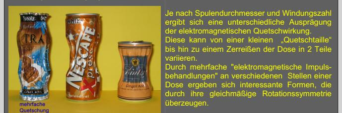
Je nach Spulendurchmesser und Windungszahl ergibt sich eine unterschiedliche Ausprägung der elektromagnetischen Quetschwirkung. Diese kann von einer kleinen „Quetschtaille“ bis hin zu einem Zerreissen der Dose in 2 Teile variieren.
