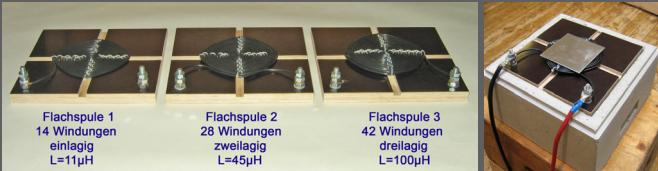
Bei einer Stanzung wird zunächst ein 2 mm dickes Aluminiumblech auf der Spule positioniert. Anschließend wird eine „Eisenplatte mit einem Stanzbolzen“ auf das Spulennetz gestellt und auf die richtige Höhe justiert. Als letztes wird die Plattform mit einem 10 kg Gewicht zusätzlich beschwert.
